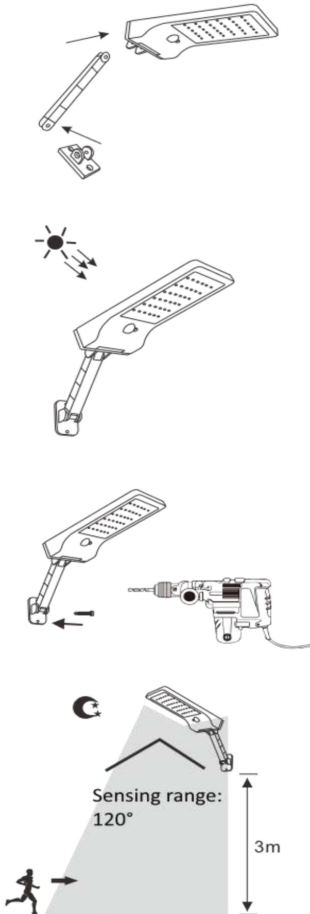
4. Leuchtkörper, Halterung und Sockel mit Schrauben befestigen.
