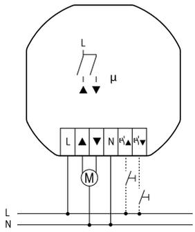
**Inbetriebnahme:** Nach dem Zuschalten der Versorgungsspannung ist der Lernmodus automatisch für 2 Minuten aktiv, wenn der Speicherinhalt leer ist (Auslieferungszustand) bzw. der Lernmodus nicht gesperrt wurde. Mit einem kurzen 'Ab, Halt' wird die Einlernbereitschaft signalisiert. Erfolgt 2 Minuten lang keine Aktion, wird der Lernmodus automatisch beendet. Dies wird mit einem kurzen 'Ab, Halt' signalisiert.
