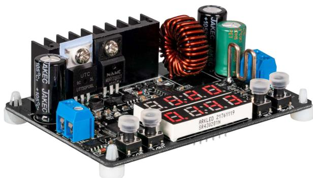
Dieses Spannungswandler Modul kann Eingangsspannungen von 6 – 40 V in eine Ausgangsspannung von 0 - 32 V herunter wandeln.
