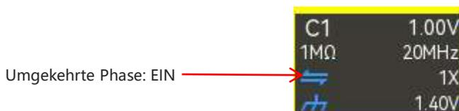
Wenn die umgekehrte Phase deaktiviert ist, wird die Wellenform normal angezeigt. Wenn die umgekehrte Phase aktiviert ist, wird die Wellenformspannung umgekehrt, und die Ergebnisse der
