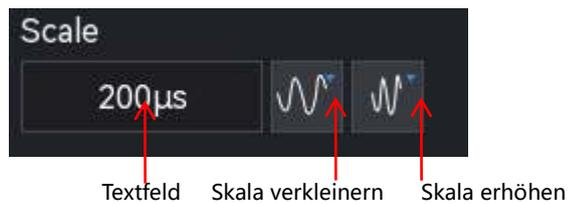
Die MSO2000X/3000X-Serie unterstützt die horizontale Einstellung. Durch Drücken des horizontalen Skalen-Drehknopfes auf der Vorderseite kann zwischen "Grobabstimmung" und "Feinabstimmung" gewechselt werden.
