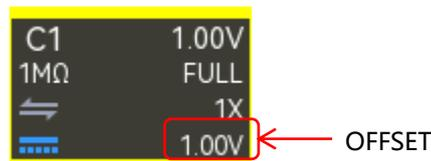
Wenn CH1 aktiviert ist, kann der vertikale Offset mit den folgenden Schritten eingestellt werden.
