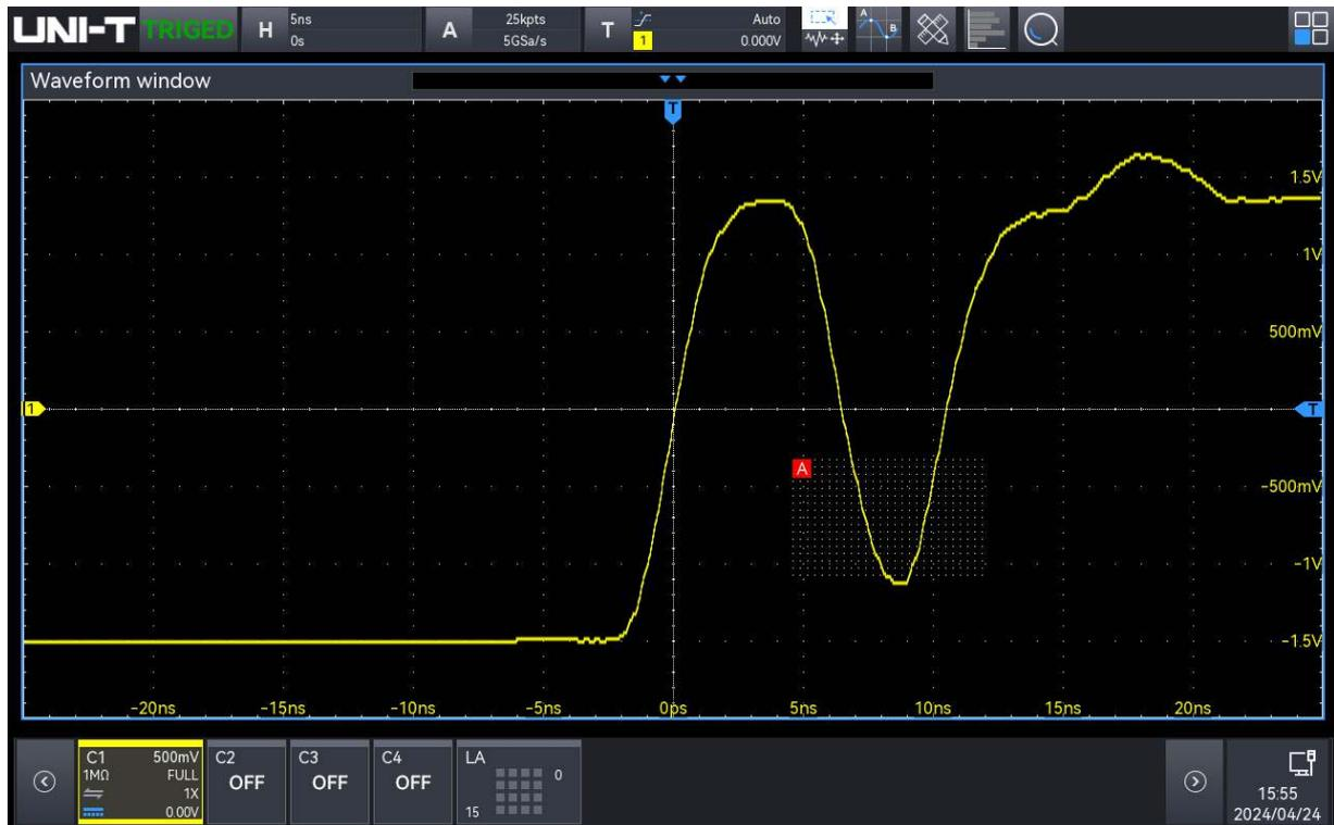
**Hinweis:** Wenn die aktuell ausgewählte Region bereits vorhanden ist, ersetzt die aktuelle Regionstrigger-Information die ursprüngliche Regionstrigger-Meldung und das Regionstrigger-Feld wird geschlossen. Wenn das Gerät neu gestartet wird, wird die Regions-Trigger-Einstellung nicht gespeichert.
