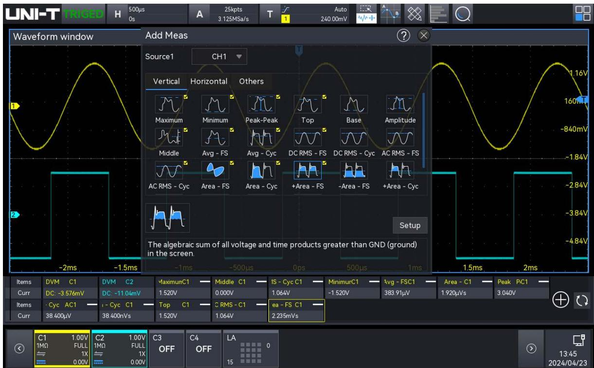
Die Parametermessung wird über der Volt/Div-Infobox angezeigt, die den Messparameter und den aktuellen Wert anzeigt. Während der Messung wird der Zähler und das Voltmeter standardmäßig ganz links angezeigt, und die benutzerdefinierten Parameter folgen dahinter. Die Parametermessung unterstützt die Einstellung von bis zu 27 Parametern.
