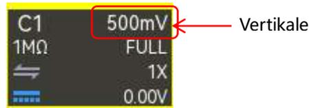
Der Bereich der vertikalen Skala hängt von der aktuell eingestellten Sonde und der Eingangsimpedanz ab. Das Standard-Tastverhältnis ist 1X. Wenn die Eingangsimpedanz 1 M $\Omega$  beträgt, ist der Bereich der vertikalen Skala 500  $\mu$ V/div  $\sim$  10 V/div; Wenn die Eingangsimpedanz 50  $\Omega$  beträgt, ist der Bereich der vertikalen Skala 500  $\mu$ V/div  $\sim$  1 V/div.
