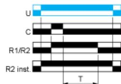
2 zeitverzögerte Ausgänge (R1/R2) oder 1 zeitverzögerter Ausgang (R1) und 1 unverzögerter Ausgang (R2 inst.)
