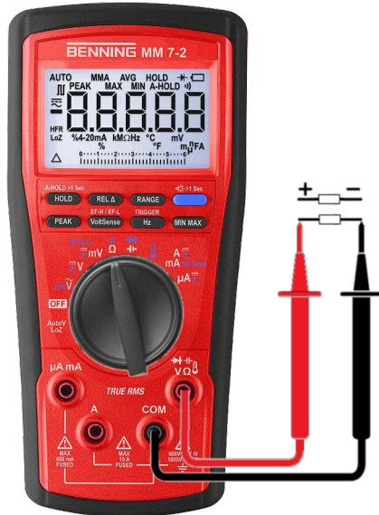
Abb. 11: Widerstandsmessung oder Durchgangsprüfung
