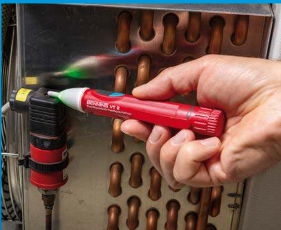
Prüfung eines Magnetventils mit BENNING VT 2
