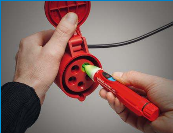
Drehfeldrichtungsprüfung an CEE-Kupplung mit TRITEST® easy
