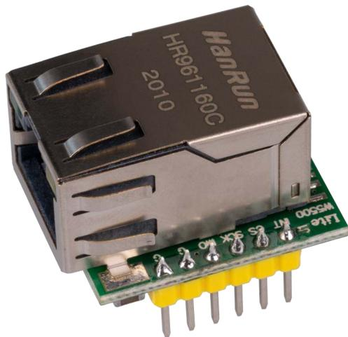
Mit diesem SPI-Ethernet Schnittstellenwandler können Sie unter anderem Ihren Arduino oder Ihren Raspberry Pi Pico um eine Ethernetschnittstelle erweitern. Außerdem ist das Modul auf Grund seiner Bauform und Größe hochintegrierbar.
