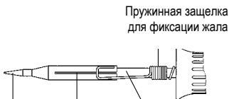
Паяльное жало Фиксирующий элемент Пружинная защелка для фиксации жала
