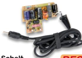
**Schalt-Netzteil mit Anschlussleitung**
