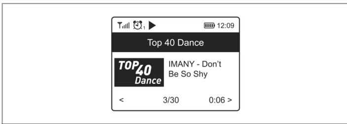
Durch Drücken der Taste ► (3) am Gerät oder der Taste (20) an der Fernbedienung, wechselt das Radio zwischen der Uhr und den Radioinformationen:
