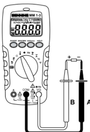
Bild 8: Durchgangsprüfung mit Summern
