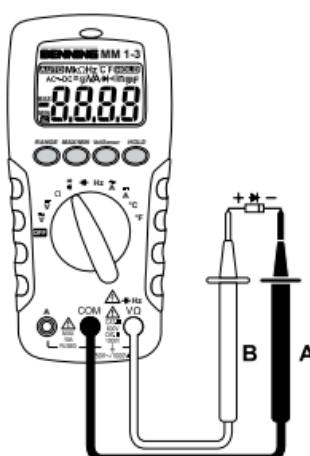
Bild 7: Diodenprüfung
