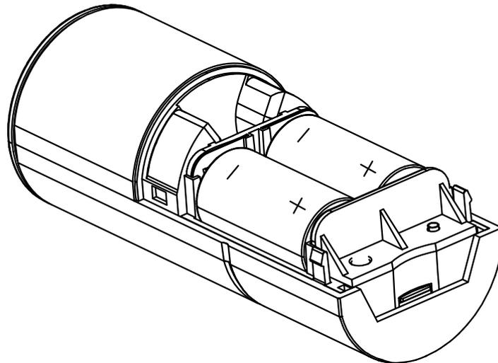
Nach dem Einlegen der Batterien führt das Gerät ein Initialisierungsblinker durch. Dabei leuchtet die Signalleuchte **(C)** mehrmals kurz rot auf und das akustische Signal für „unscharf“ wird ausgegeben. Danach ist das Gerät betriebsbereit. Über die Anlerntaste **(E)** können Sie die Sirene sofort bedienen.
