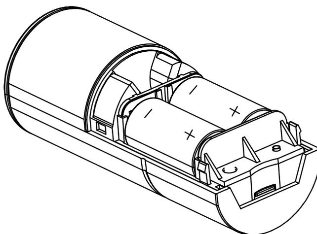
Nach dem Einlegen der Batterien führt das Gerät ein Initialisierungsblinker durch. Dabei leuchtet die Signalleuchte (C) mehrmals kurz rot auf und das akustische Signal für „un-
