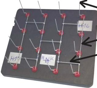
Hier ist im Bild zu sehen, wie mit einer Montagehilfe die Ebenen zwei, drei und vier vorbereitet werden können. Die Anoden werden abgewinkelt und anschließend an den Endpunkten der Anschlussdrähte verzinnt.
