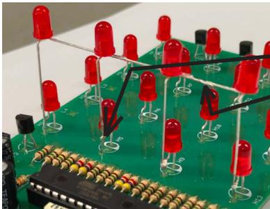
Sollte keine Montagehilfe zur Verfügung stehen, werden zuerst die Anoden und die Kathoden der LEDs so gebogen, wie sie auch zum Einsetzen in die Montagehilfe gebogen werden würden.
