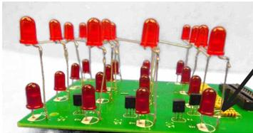
Dazu werden die Endpunkte der Anoden der oberen Ebene mit den Knickpunkten der Anoden der unteren Ebene verlötet.
