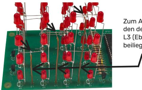
Zum Abschluss werden die zusammengeführten Kathoden der einzelnen Ebenen mit den Löt pads L2 (Ebene 2), L3 (Ebene 3) und L4 (Ebene 4) verbunden. Dazu wird der beiliegende Schaltdraht verwendet.
