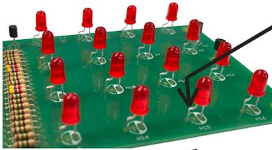
Im Bild links ist die erste Ebene des LED Cube dargestellt. Der Pfeil deutet auf den abgewinkelten Pin, der bei jeder LED zu verzinnen ist, um die darüber liegende Ebene leichter anlöten zu können.
