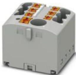
Verteilerblock, Grundklemme mit Einspeisung, Die Blöcke sind untereinander über den Leiterschacht brückbar. Passende Steckbrücken siehe Zubehör, Nennspannung: 450 V, Nennstrom: 24 A, Anschlussart: Push-in-Anschluss, Push-in-Anschluss, Anzahl der Anschlüsse: 7, Querschnitt: 0,14 mm<sup>2</sup> - 4 mm<sup>2</sup>, AWG: 26 - 12, Breite: 25,6 mm, Höhe: 21,7 mm, Farbe: grau, Montageart: aufrasten auf Tragschienenadapter, Adapterplatte
