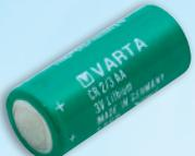
Lithium-Batterien bieten gegenüber anderen Primärzellen Vorteile wie höhere Energiedichte, hohe Zellenspannung und längere Lagerfähigkeit aufgrund sehr geringer Selbstentladung. **Technische Daten:** // 2/3 AA (Mignon) // Spannung: 3 V // Kapazität: 1350 mAh // Gewicht: 15 g // Maße ØxL: 14,75x33,1 mm.
