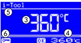
Im Arbeitsmodus kann die Lötspitztemperatur direkt durch Drehen des i-OP verändert werden. Bestätigt wird dies durch Drücken des i-OP. Lesen Sie hierzu auch den Abschnitt 6.3.19 [Festtemperatur].
