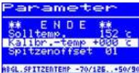
Diese Funktion dient zur Kalibrierung der Lötspitzentemperatur. Sie ermöglicht das Abgleichen von Anzeigewert und tatsächlicher Spitzentemperatur. Der einstellbare Kalibrierbereich beträgt  $-70$  bis  $+50$  °C /  $-126$  bis  $+90$  °F. Das genaue Vorgehen bei der Kalibrierung ist im Kapitel 6.3.5 [Kalibrieren] beschrieben.
