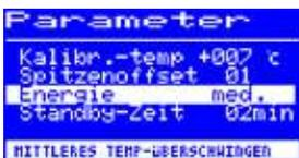
Diese Funktion gestattet es dem Anwender, das Regelverhalten der Station zu beeinflussen, wodurch das Auf- und Nachheizverhalten der Station auf das jeweilige Einsatzgebiet angepasst werden kann. Bei i-TOOL, X-TOOL VARIO, CHIP TOOL VARIO und TECH TOOL sind
