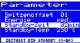
Die Standby-Zeit ist die Zeitspanne vom letzten Arbeiten mit dem Lötwerkzeug bis zu dem Zeitpunkt, an dem die Standby Temperatur aktiviert wird. Der Einstellbereich beträgt 20 Sekunden bis 60 Minuten. Die Eingabe von [0] deaktiviert die Standby Funktion.
