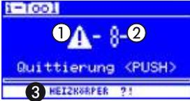
Die Lötstation führt selbständig Fehlerdiagnosen durch. Das Ergebnis einer Diagnose wird als Fehlercode ausgegeben: Dabei erscheint das dreieckige Piktogramm ① im Display der Lötstation. Der Fehlercode ② wird als Zahl zwischen 2 und 99 angezeigt.
