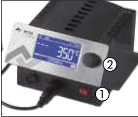
Das Ein/Ausschalten der Lötstation wird durch den auf der Frontseite befindlichen ① ausgeführt. Wenn die Lötstation eingeschaltet ist, leuchtet der Schalter rot.
