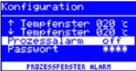
Wenn die aktuelle Werkzeugtemperatur das Temperaturfenster verlässt, ertönt ein einfaches akustisches Signal. Wenn die Werkzeugtemperatur wieder in das Temperaturfenster zurückkehrt, ertönt ein doppeltes akustisches Signal. Werkseinstellung: [off].
