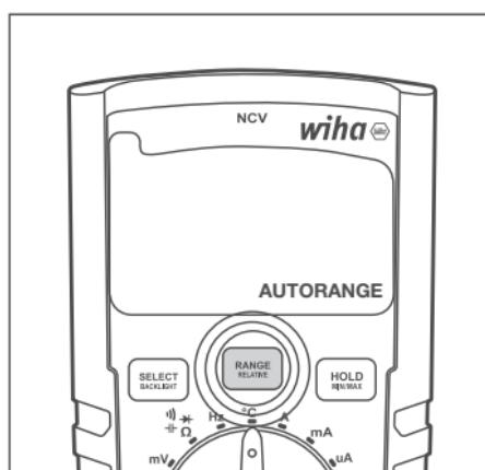
Multimeter geht gleichzeitig in den relativen und manuellen Bereichsmodus über.
