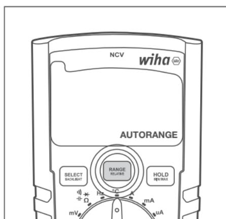
Yleismittari siirtyy suhteelliseen ja manuaaliseen aluetilaan samanaikaisesti.
