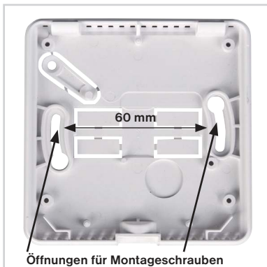
Abb.3 Befestigen Sie den hinteren Teil des Melders an die Wand.
